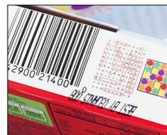
Code illisible et mal positionné
