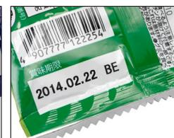
Code impeccable obtenu par impression à transfert thermique
